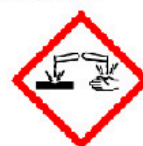
«Жидкости, выливающиеся из двух пробирок и поражающие металл и руку» [11].
