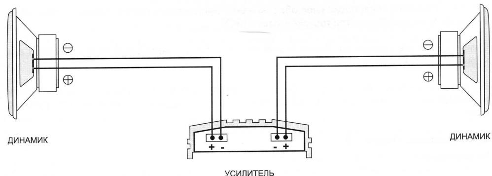
Б) Схема подключения компонентных динамиков.
