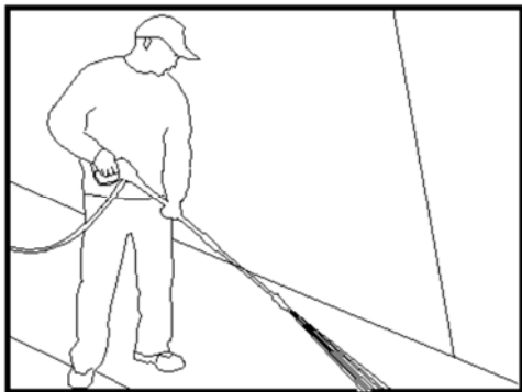
Рис. 6 - Оптимальный угол распыления воды относительно поверхности
